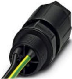
Wanddurchführung, QUICKON-Anschluss, Polzahl: 2+PE, 0,5 mm<sup>2</sup> ... 1,5 mm<sup>2</sup>, 690 V, 17,5 A, schwarz, mit QUICKON-Mutter, Kabeldurchmesser: 4 mm ... 9 mm, Montagegewinde: M20, Einzeladern, 1,5 mm<sup>2</sup>, Leitungslänge: 1 m
